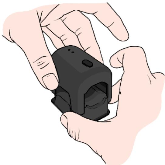
Sujete el dispositivo por las pestañas de agarre y levante la carcasa superior para permitir que la introducción el dedo.
